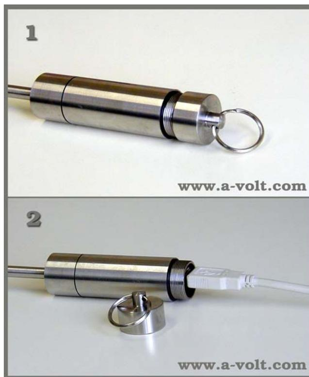
图 1-1 温度记录器与下载电缆的连接方法
